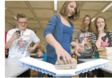
6 Belastungsprobe für eine Papierbogenbrücke
