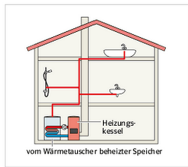
3 Gruppenversorgung durch die Zentralheizung
