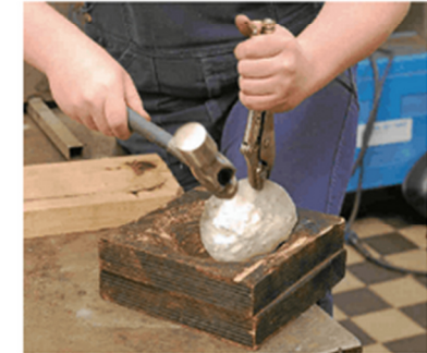
5 Ein Messingblech wird zu einer Schale getrieben.
