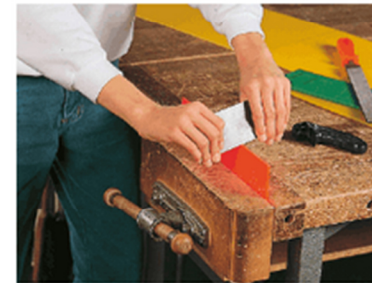
3 Abziehen mit der Ziehklinge
