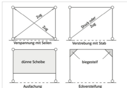
3 Stabilisierung von Rahmen
