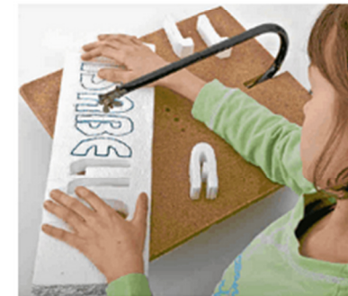
4 Trennen mit der Thermoäge
