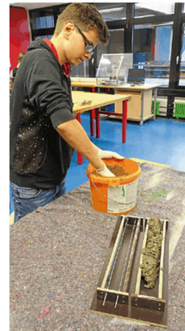
4 Modell eines Stahlbetonträgers
