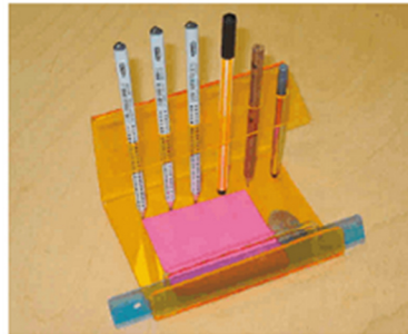
1 Durch Biegeumformen hergestellter Stifthalter mit Notizblock
